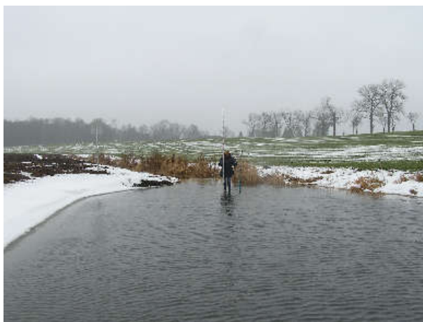
5.5 pav. Nešmenų kiekio matavimai šlapynės giliojoje dalyje 2016 m. žiemą
