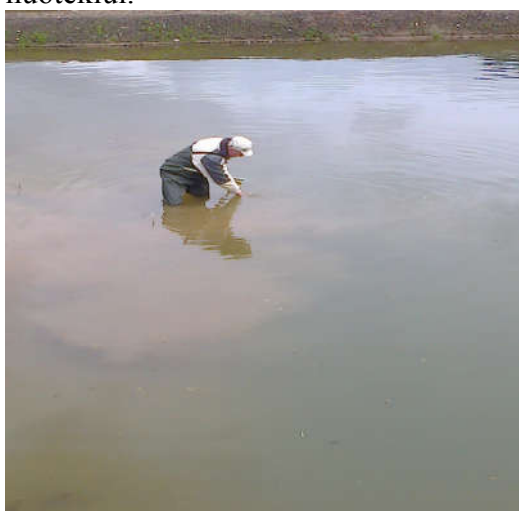
5.1.1 pav. Dugno nuosėdų mėginių ėmimas vidutiniam nešmenų dalelių skersmeniui nustatyti
