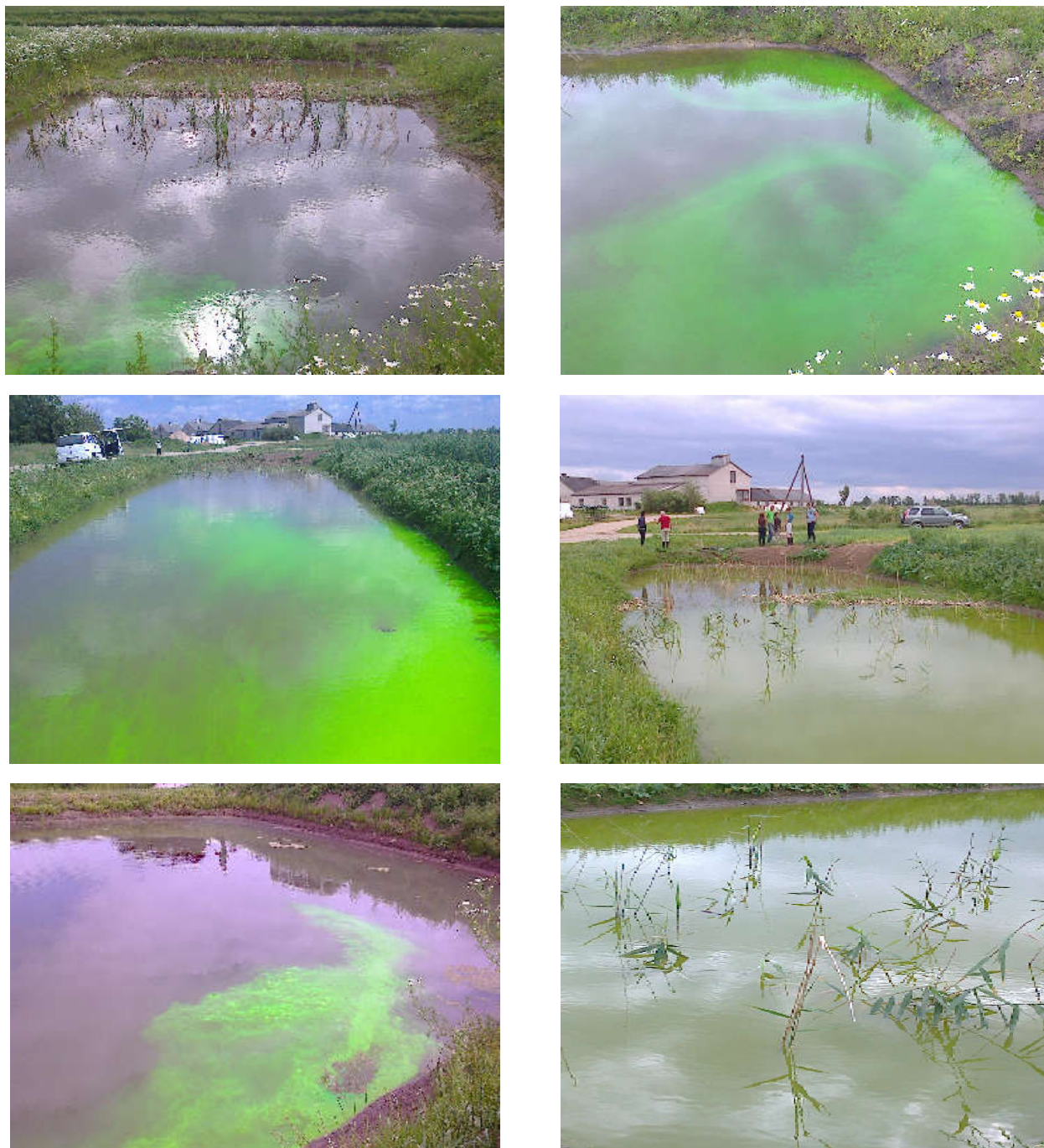
5.2.8 pav. Sedimentacijos tvenkinėlių vandens sulaikymo pakartotiniai matavimai (kairėje vaizdas supylus markerius, dešinėje – po 7 parų)
