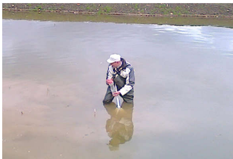
5.1.1 pav. Dugno nuosėdų mėginių ėmimas vidutiniam nešmenų dalelių skersmeniui nustatyti
