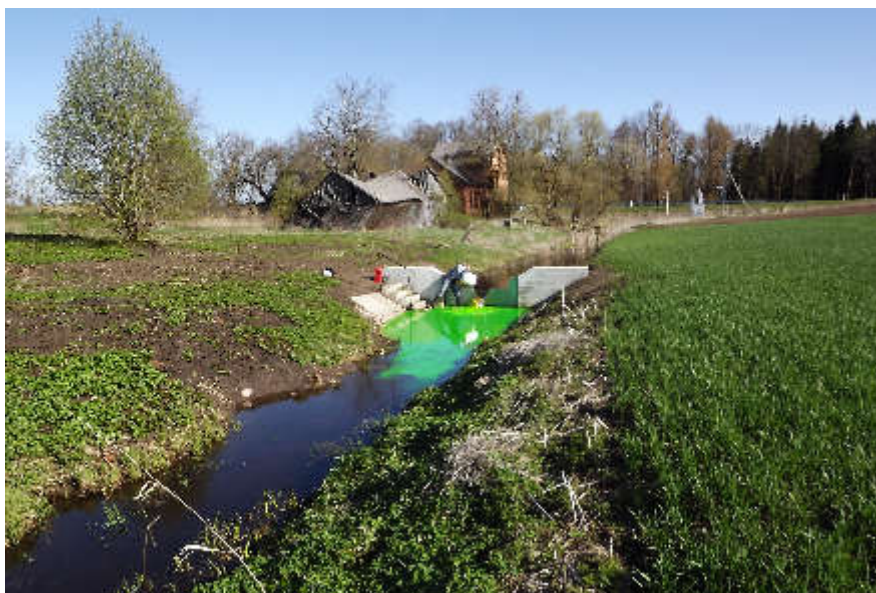
5.2.2 pav. Markerių supylimas šlapynės įtekėjimo dalyje (2015-04-21, 9:40)
